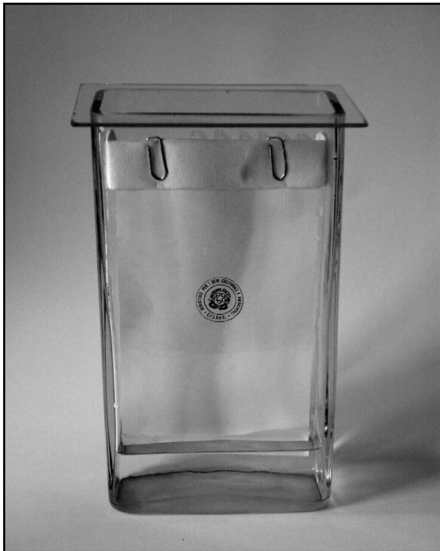
Fig. 1: Decolorazione del timbro con il metodo cromatografico.
