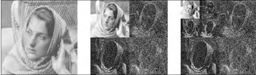
Fig. 3. Immagine decomposta in sottofrequenze mediante lo schema di Mallat: l'immagine in alto a sinistra è il thumbnail , la cima della piramide. Il JPEG 2000 opera comprimendo in maniera intelligente le sottofrequenze dei piani di crominanza.
